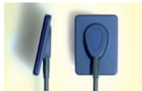
Design del sensore XIOS: forma estremamente piatta con spigoli arrotondati.
