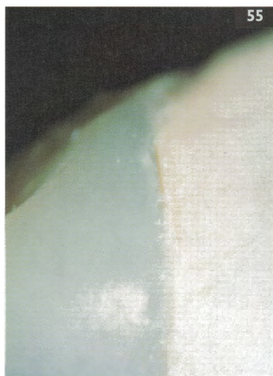
Fig. 55 - Distacco del composito dal gesso (25X)
